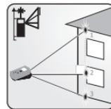
Tercero, presione para obtener Pitágoras doble (medición parcial). Calcule la distancia entre el punto 1 y el punto 2.
