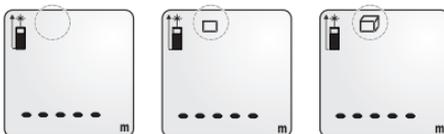
Siga las instrucciones de la línea titilante en la pantalla para medir la longitud, el ancho y la altura. Presione y suelte
